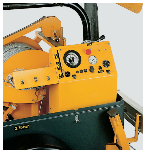
Dynamometer med indikator for tillatt trekk og automatisk cut-off. Ingen registrering av data.
