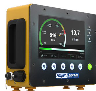
MP 50 er elektronisk enhet med 7" TFT touchscreen display som gir deg oversikt over trekkrefter og hastighet slik at man har full kontroll under strekking. Man har mulighet til å logge og registrere strekkingen samt eksportere denne rapporten i PDF via USB eller trådløst til din mobil eller nettbrett.
