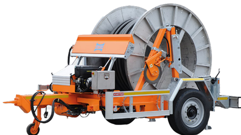
Trommelhenger KVH med tosidig drift
