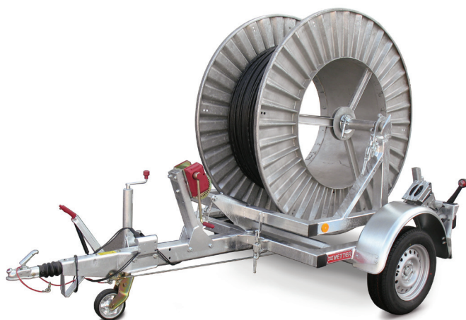
Trommelhenger KVS (G), trommelhenger med rett drag, utstyrt med kulekobling
