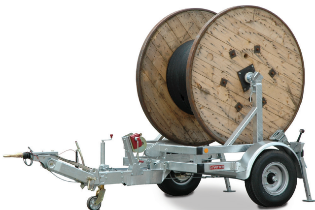
Trommelhenger KVS (H), trommelhenger med justerbart drag og kulekobling
