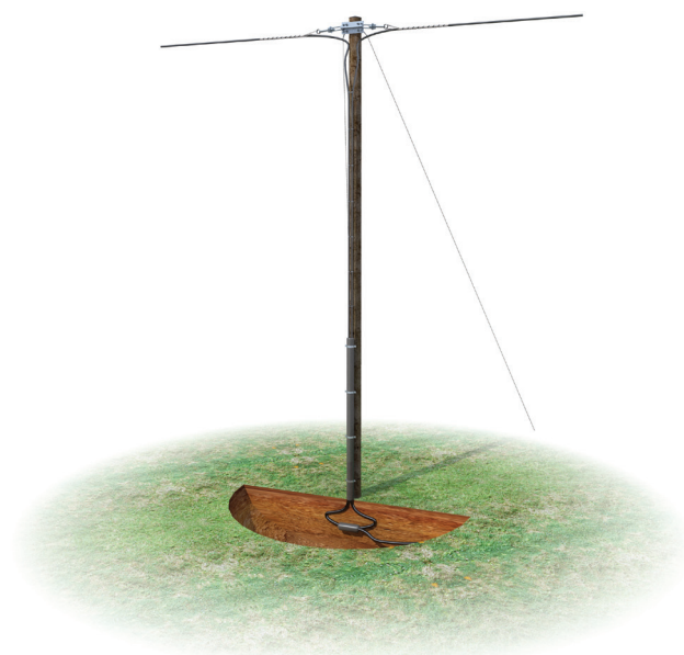
E-mast m/bufferkveil og kabel
