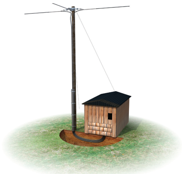
E-avgreningsmast m/ kiosk
