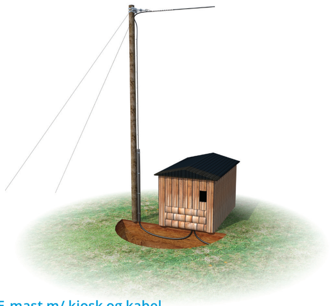
E-mast m/ kiosk og kabel
