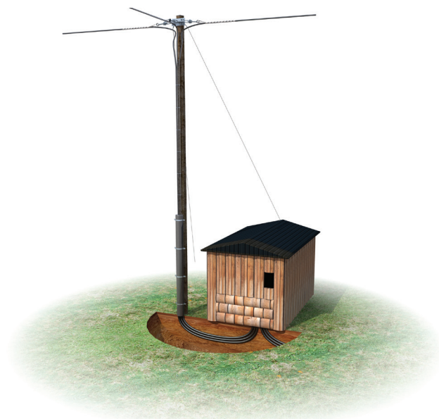
E-avgreningsmast m/kiosk og kabel
