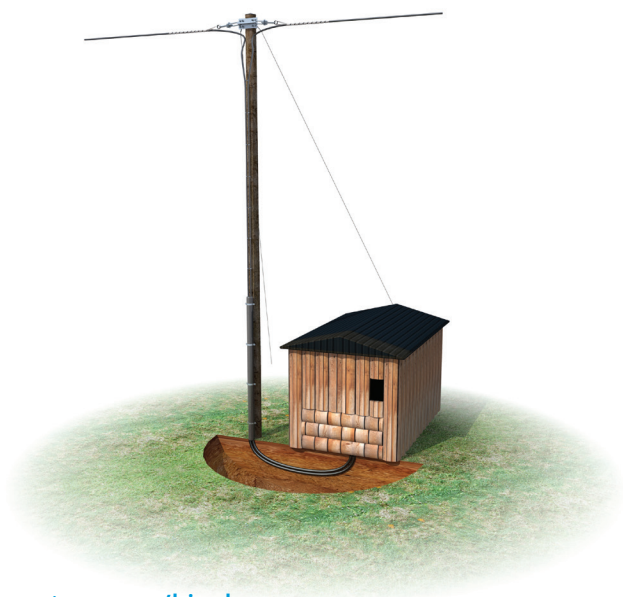
E-mast avsp m/kiosk
