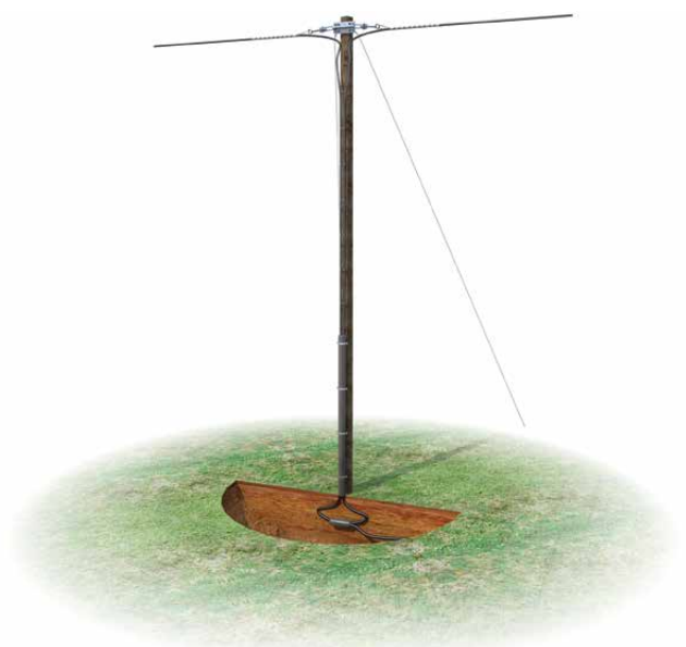
E-mast m/bufferkveil og kabel
