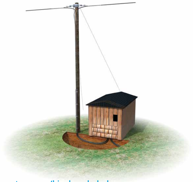
E-mast avsp m/kiosk og kabel
