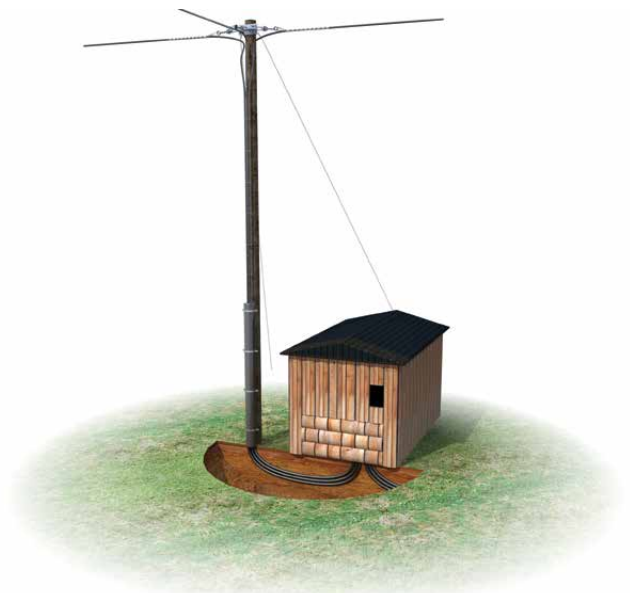
E-avgreningsmast m/kiosk og kabel
