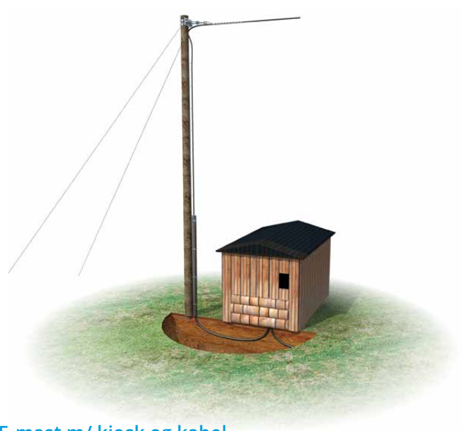
E-mast m/ kiosk og kabel
