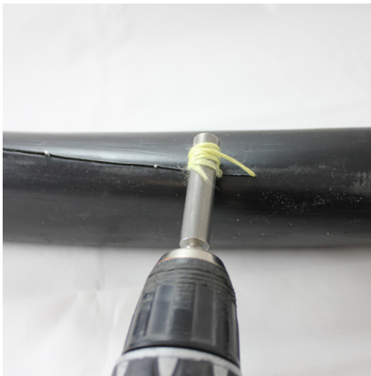
Linki z włókna kevlarowego umieszczone wewnątrz kabla ułatwiają przecinanie i usunięcie powłoki zewnętrznej
