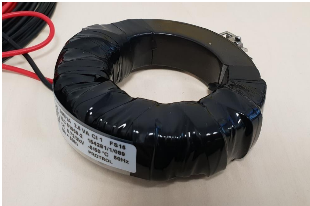
Figur 5. Öppningsbar strömtransformator av ringkärnetyp för mätning av ström i kabelpart
