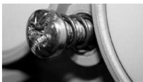
Vis de sécurité desserrée
