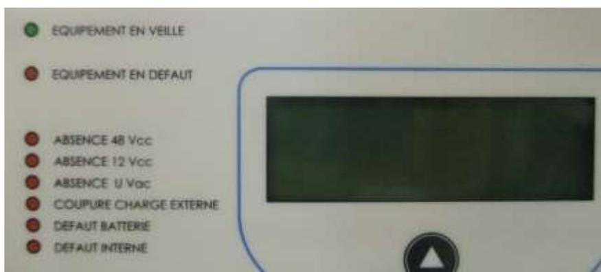
Les défauts visualisés sur les Leds sont les suivants
