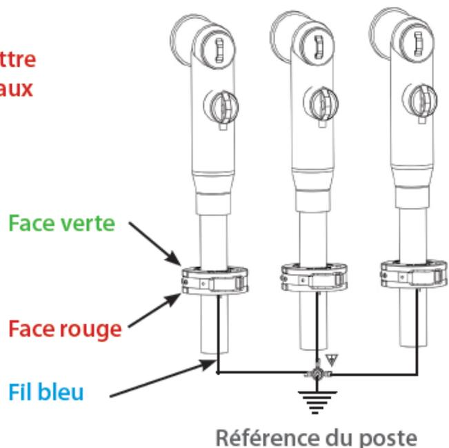
Relier l'ensemble des prises de terre des capteurs (fil bleu muni d'une cosse ronde) à la référence du poste. la tresse de mise à la terre de l'écran du câble HTA doit obligatoirement passer à l'intérieur des tores
