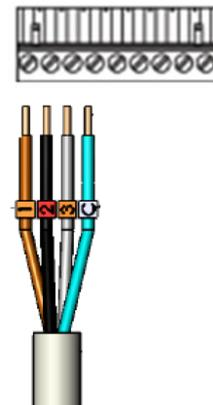
**NOTA :** Pour simplifier le raccordement, il est possible de décrocher le connecteur 9 plots vert.
