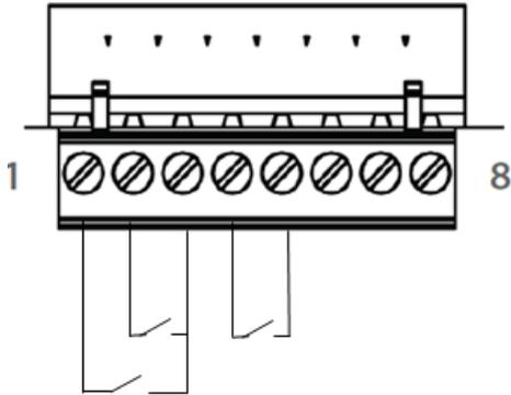
Les entrées contacts secs sont à câbler entre l'entrée du signal désiré (Ex : Défaut urgent) et une entrée 0V.
