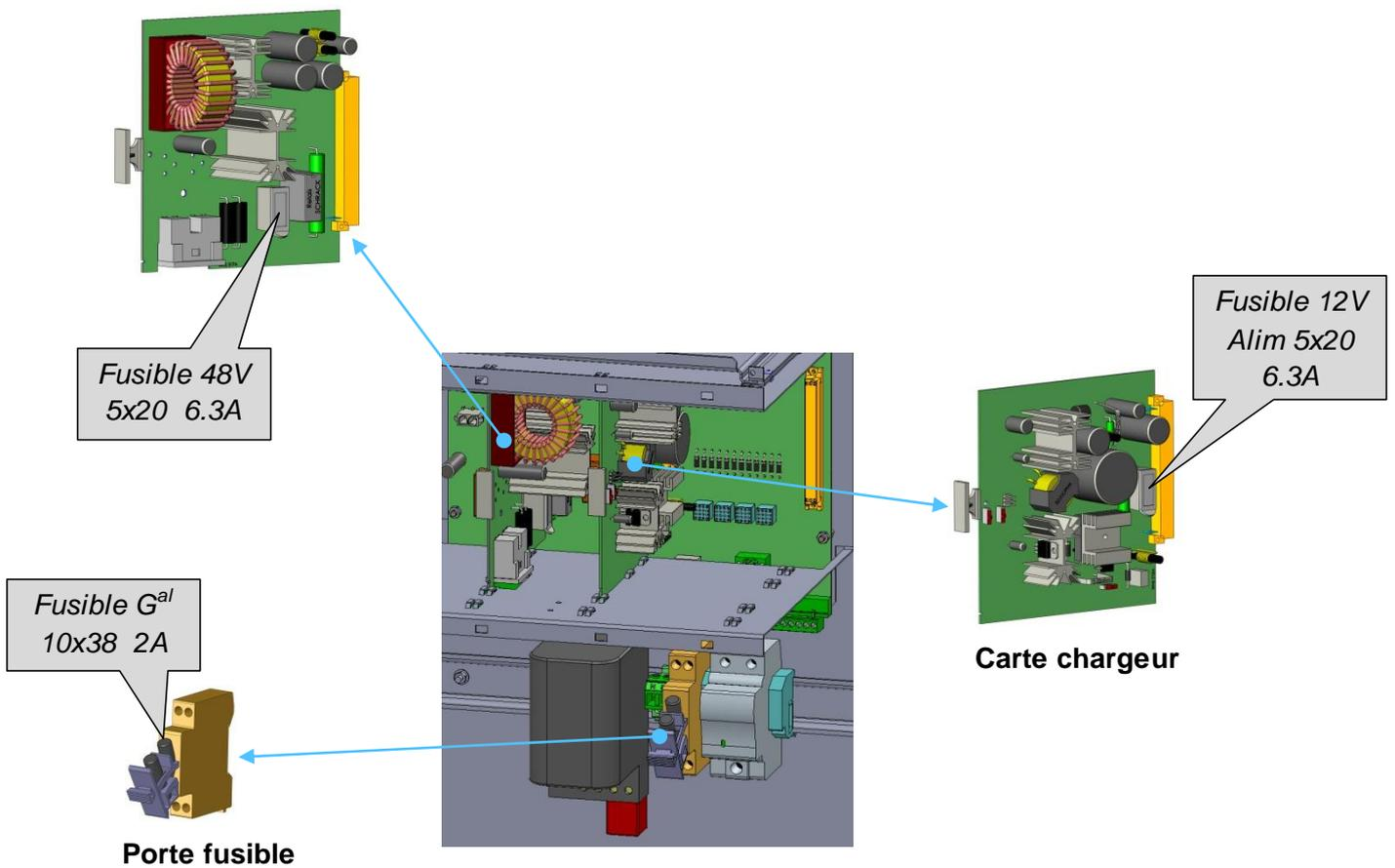
En cas de dysfonctionnement du matériel (identification du problème voir §5.1), il peut être nécessaire de changer un élément du coffret (carte électronique, batterie, câble, ...)
