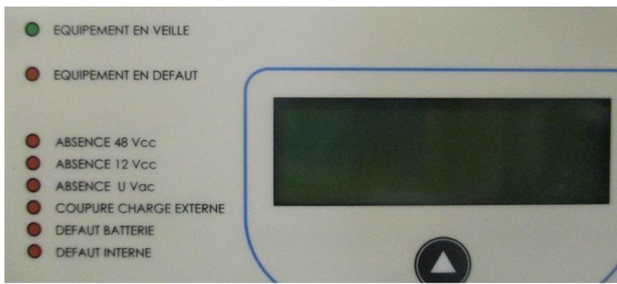
Les défauts visualisés sur les Leds sont les suivants
