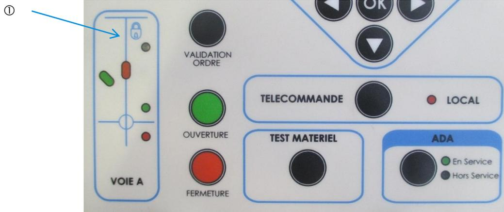
Pour réaliser une commande de fermeture, appuyez simultanément sur les boutons "FERMETURE" et "VALIDATION ORDRE". Après la fermeture le voyant rouge de position s'allume
