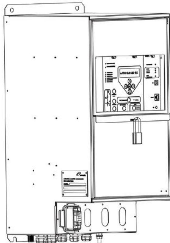
**Niveau 1 : Exploitation** : accessibilité aux agents d'exploitation. Seul l'IHM est accessible. La condamnation du niveau supérieur est réalisée à l'aide de deux scellés.
