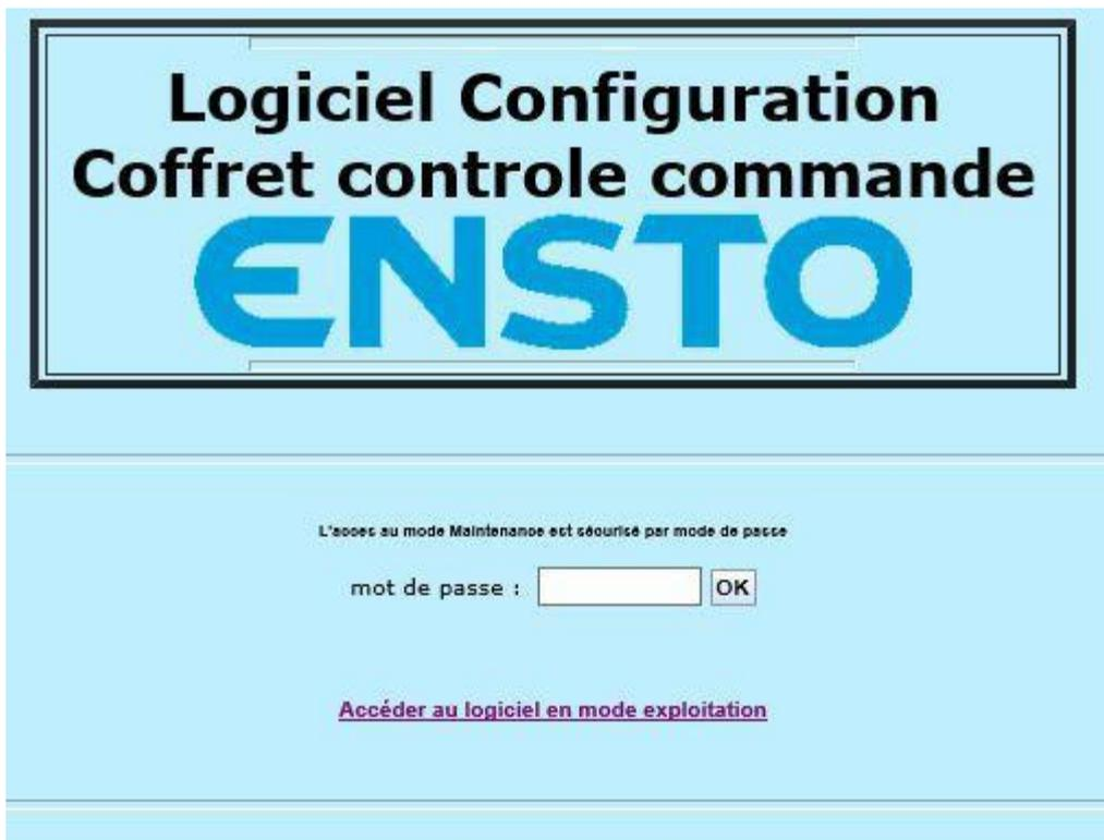
Afin de programmer les paramètres du coffret, il est nécessaire de se mettre en **mode Maintenance** (mot de passe par défaut «novexia»). De plus, mettre en local le produit pour la prise en compte de la configuration.
