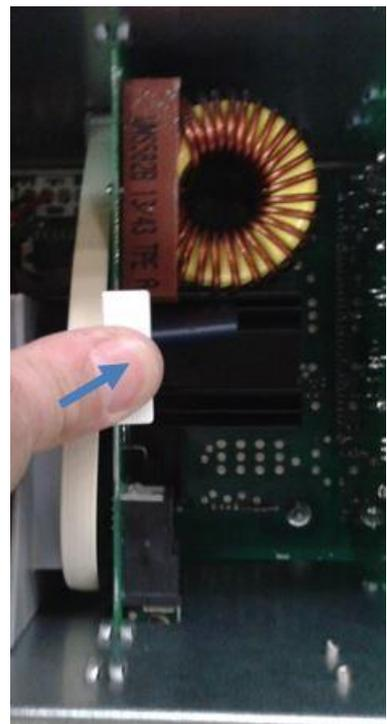
Repositionner les clips de verrouillage du haut et bas de carte et reconnecter le câble.
