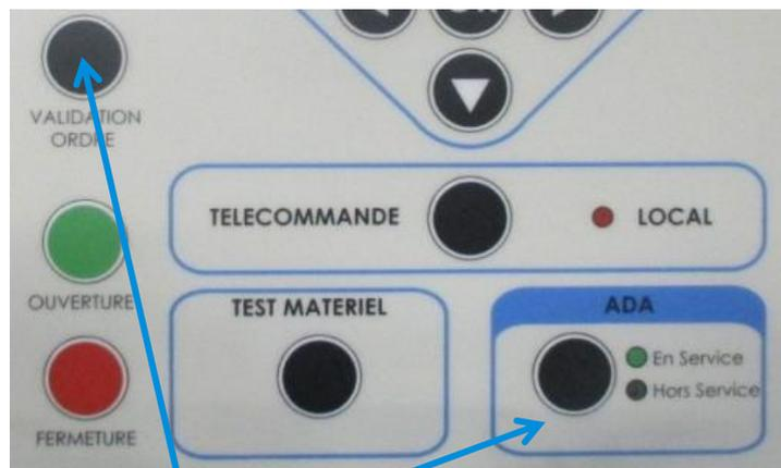
Pour réaliser une mise En service de la fonction ADA, appuyer simultanément sur les boutons "ADA" et "VALIDATION ORDRE". Après la mise en service le voyant vert "ADA En service" s'allume
