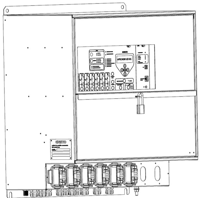
**Niveau 1 : Exploitation** : accessibilité aux agents d'exploitation. Seul l'IHM est accessible. La condamnation du niveau supérieur est réalisée à l'aide de deux scellés.
