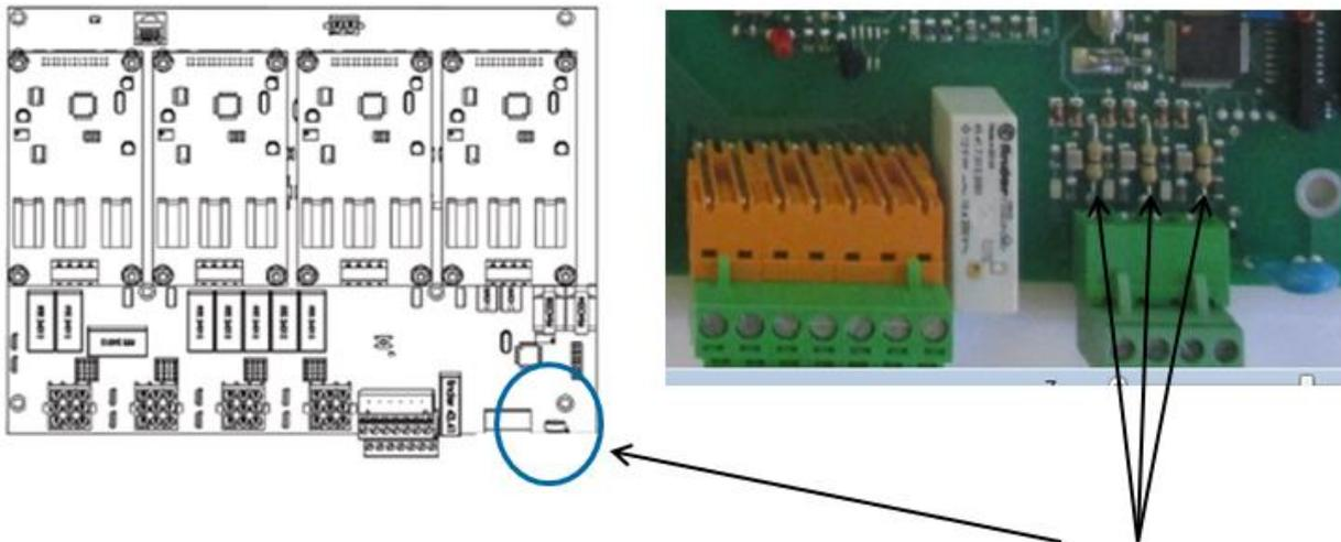
Pour cela il est nécessaire de couper avec une pince coupante adéquate les 3 résistances classiques en bas et à droite de la carte filerie. La méthodologie d'étalonnage est alors identique à celle décrite ci-dessus et présentée au sein du §3.2.
