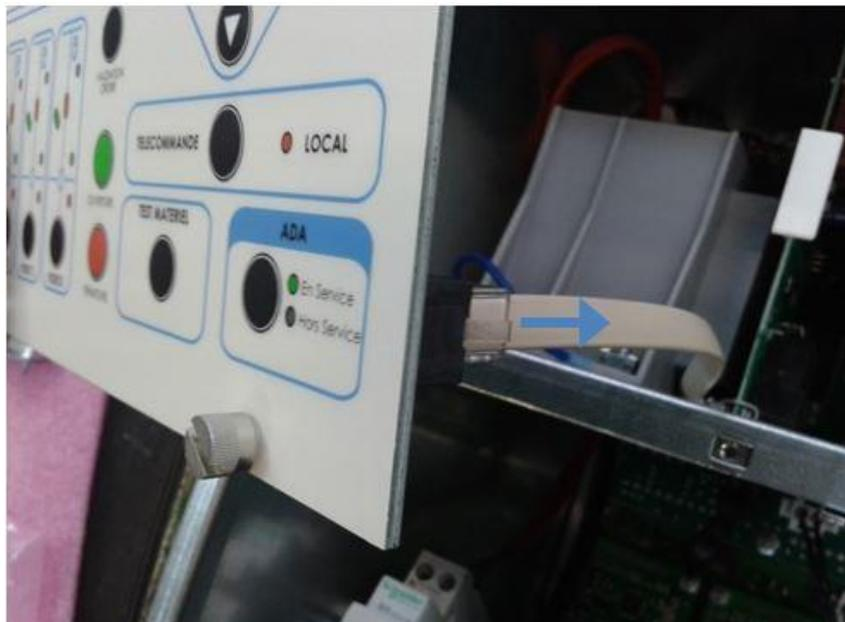
Il est nécessaire d'enlever les clips de verrouillage pour extraire les cartes chargeur et convertisseur.
