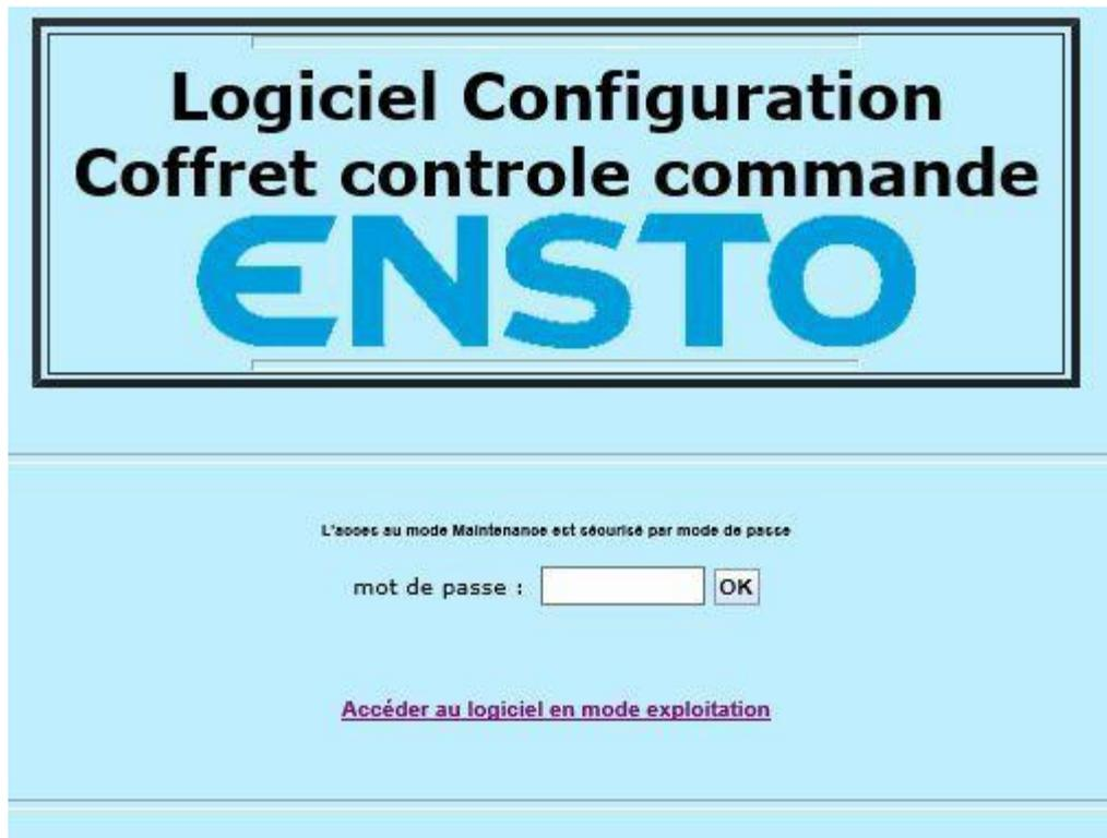
Afin de programmer les paramètres du coffret, il est nécessaire de se mettre en **mode Maintenance** (mot de passe par défaut «novexia»). De plus, mettre en local le produit pour la prise en compte de la configuration.
