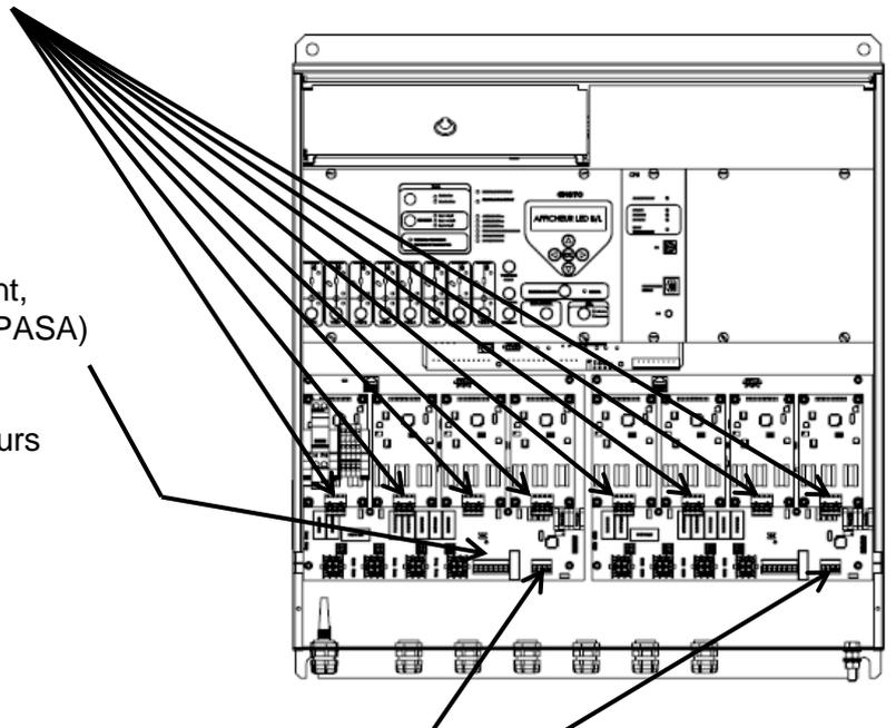
**Connecteurs liaison capteur de tension PPACS**
