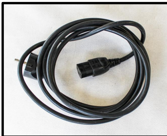
Câble ADA (permet de tester la fonction ADA des coffrets ITI)
